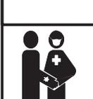
**Risques d'injection et d'explosion:** Une pulvérisation ou des fuites à haute pression peuvent provoquer une injection de produit dans le corps.
